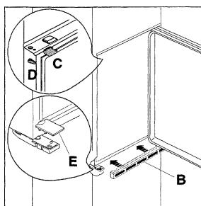
4. Установить вентиляционную решётку (B) и накладку петли (E), защёлкнув их. Вставить крышки (C-D) в отверстия петель.
